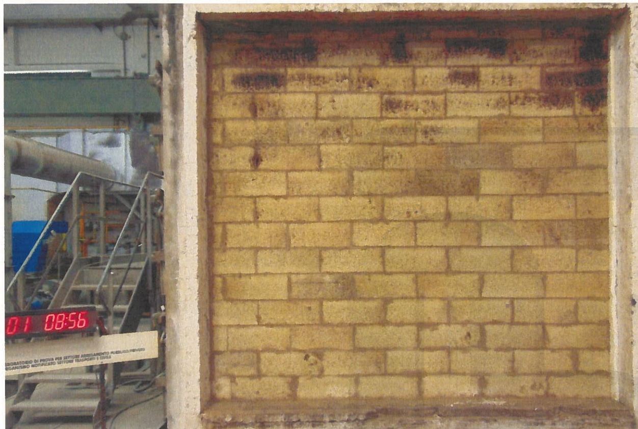
Foto 5: Lato non esposto al termine della prova
