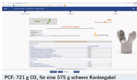
BILD 2 Eingaben und beispielhaftes Ergebnis für den CO 2 -Fußabdruck einer Kardangabel im Softwarewerkzeug FRED (© prosimalys)
