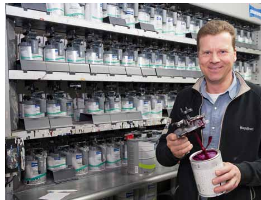
In der modernen Mischanlage stehen 72 Grundfarben auf Wasserbasis zur Verfügung. Sie werden mehrmals am Tag automatisch aufgerührt, damit sich keine Farbpigmente absetzen.
