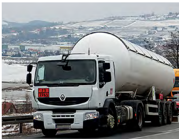
Autocysterny są bardzo popularną metodą transportu LPG z terminali do składów lub klientów, nawet przy bardzo niskich temperaturach, jak widać na załączonym zdjęciu.
