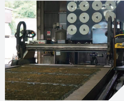
等離子切割機 精準切出特殊形狀、尺寸的板材
