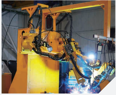
自動化焊接機械臂 精準及快捷加工地基工字槽
