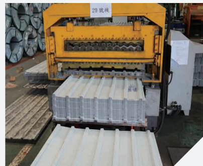
坑板壓製機 制作特長5坑、7坑及圓坑鋅彩板
