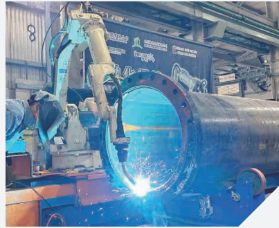
自動化焊接機械 電腦數控操作為工件進行焊接加工
