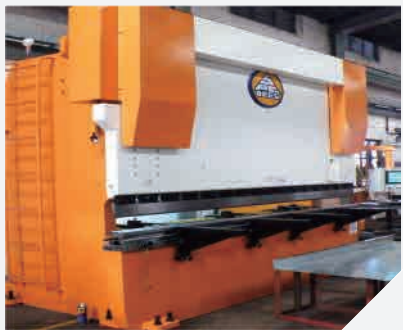
數控油壓折床 電腦數控配合液壓系統，屈折板材
