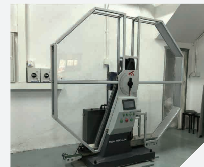
撞擊測試機 將鋼材樣本進行撞擊測試
