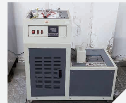
高低溫試驗裝置 對材料進行高溫及低溫測試
