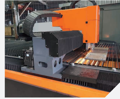
雷射切割機 切割不銹鋼、銅、鋁等材料
