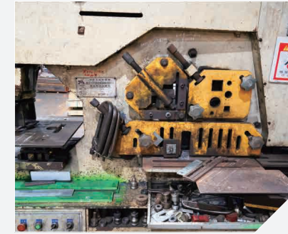
多功能剪切機 可將不同型材進行切割或打孔
