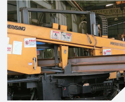
移動帶鋸 切割工字、開板及管材
