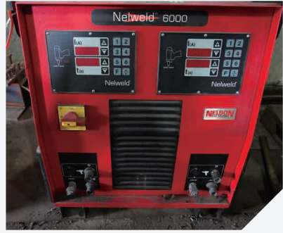
種釘機 可將種釘焊接於不同鋼材上
