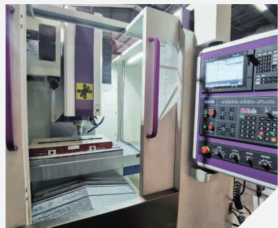
數控銑削加工中心 鑽孔、銑平面/斜面/曲面、攻牙等
