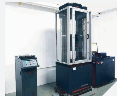
拉力測試機 將鋼材樣本進行拉力測試
