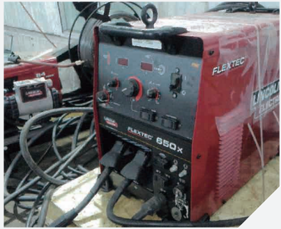
林肯多功能焊接機 以多工藝電弧特性進行厚材焊接
