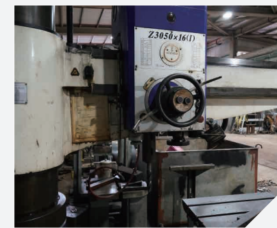
油壓搖臂鑽床 將板材及型材等進行大直徑鑽孔
