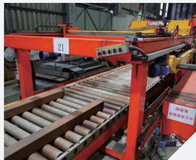
細筒直片機 「飛剪」鍍鋅材料製作平板
