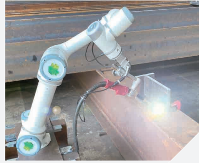
焊接機械人 自動化焊接不同工件
