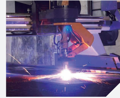
等離子切割機 等離子可切出工件坡口切口
