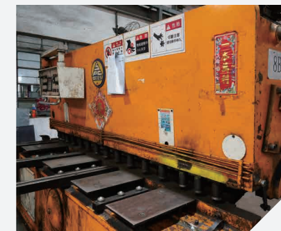
HS油壓剪床 電腦數控板材剪切
