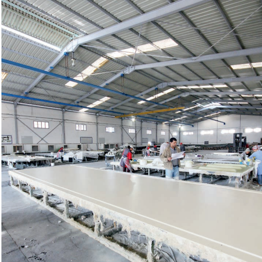
Laminieren von Flachelementen bei ITAP
