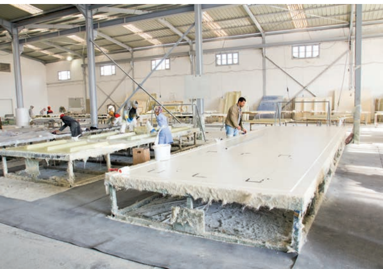
Fertigung von Abdeckelementen bei ITAP
