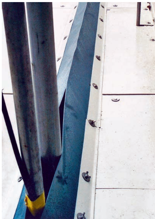
Gut sichtbar: Die Lippen öffnen sich nur im Bereich des durchfahrenden Gestänges
