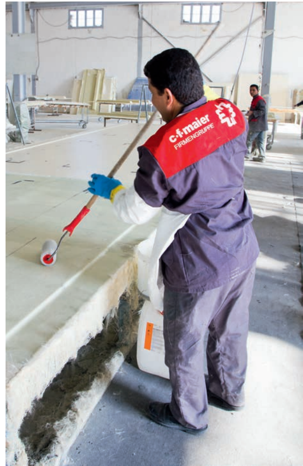
Laminieren von Flachelementen bei ITAP
