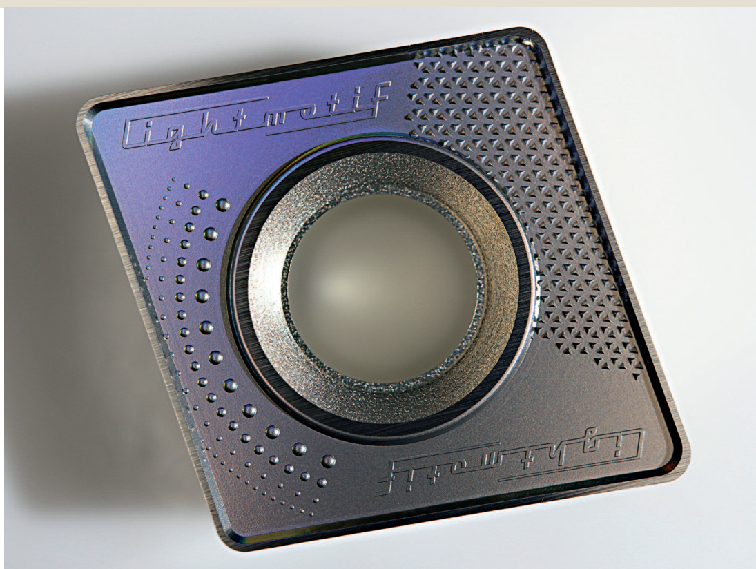
Bild 1. Demostruktur in Hartmetall (Wolframcarbid-Kobalt)
