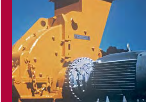
Optimale Ausnutzung der Motorleistung durch Voith Turbokupplungen am Prallbrecher bei der Zerkleinerung von Mineralien.
