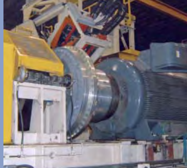
Turbokupplung 750 TVVF im Antrieb eines Stranders, der bei Einsatz eines elektrischen Sanftanlaufgerätes zur Begrenzung des Motorstroms nicht direkt angefahren werden kann.
