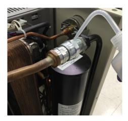
Figure 17 Leak Check Aeroquip Couplings
