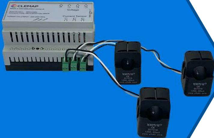
Das CLEMAP Load Management dient der vollständigen Überwachung des Energieverbrauchs von 42 A bis 6'000 A und zur Durchführung des Echtzeit-Lastmanagements von Ladestationen von Elektrofahrzeugen, wodurch die sonst notwendige Erhöhung der Hauptanschlussleistung vermieden wird. Es wird in Schaltschränken oder Verteilerschränken installiert und fungiert als dezentrale Messstelle.
