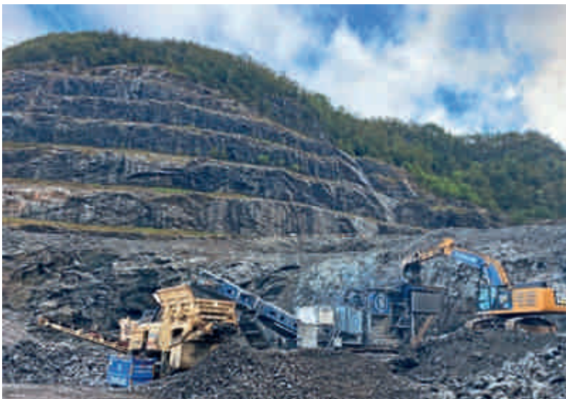
Ole Aleksander laster grovknuseren, og transportbåndene fører steinen videre til trommelen. Stein som er for store, føres i eget depot og må en runde ekstra i knuseren for å få rette størrelsen.
