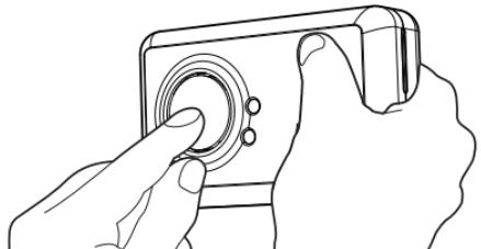
**Stap 2** Bedek de openingen van het alarm met één hand. Houd de testknop ingedrukt met uw duim/vinger totdat de gele foutindicator brandt en het alarm een tweede maal luid piept (dit zou na 5 seconden moeten gebeuren). Laat de testknop los. Zodra u de testknop loslaat, zal de gele foutindicator om de seconde knipperen. Dit geeft aan dat de monsternemingsfrequentie van de koolmonoxidemelder is verhoogd en kan worden getest met een geadviseerde bron van Koolmonoxide.
