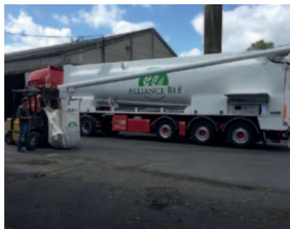
De multitrailer heeft een zwenkarm die naar ieder gewenste losplaats kan zwenken.
