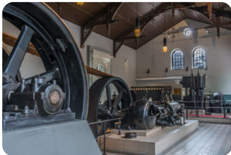
Het hart van de weverij: de grote twee-cilindrische stoommachine van 1917 (Foto: LWL / Holtappels)
