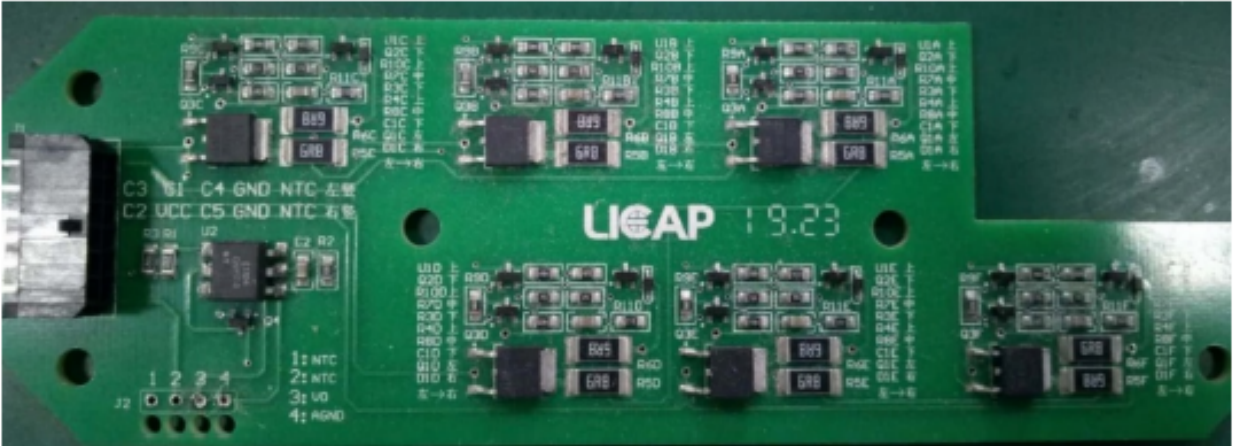
图2PCBA照片,显示了我们16V/500F模组中六组平衡电路单体。
