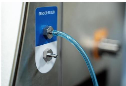
**Figura 22:** Conexión de tubería celeste del sensor de flujo
