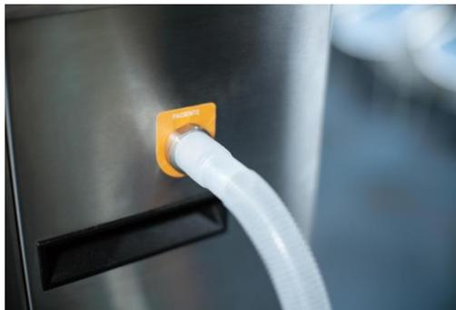
**Figura 18:** Conexión de tubo corrugado
