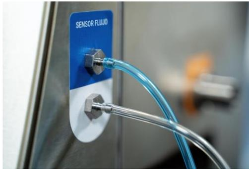
**Figura 23:** Conexión de tubería transparente del sensor de flujo
