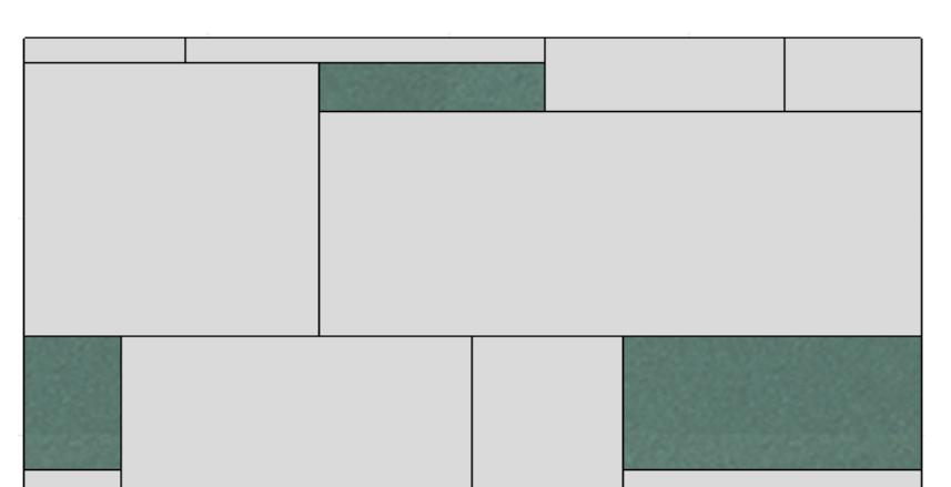
Die 106 grauen und 28 grünen Faserzementplatten geben der Fassade ein Gesicht. Die großformatigen Carat Fassadenplatten, haben diverse Größen um eine gewisse 3 Dimensionalität in das Bild zu bringen, sind allerdings bis auf den Dachabschluss immer Orthogonal zugeschnitten. Die Fassadentafeln sind auf einer Aluminiumunterkonstruktion angebracht und für nähere Informationen, siehe Details.
