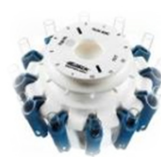
Hettich wash rotor Rotolavit
