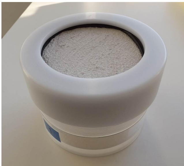
Figure 8. Dry cup avec au fond du pot un gel de silice blanc et en haut sous le couvercle vissant le matériau de plaque, avec joint en caoutchouc mousse et une bande en caoutchouc butyle.
