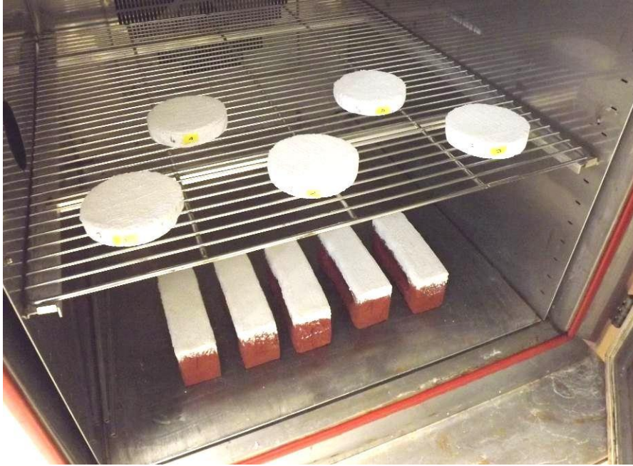
Figure 2. Conditionnement humide des échantillons dans une enceinte climatique, jusqu'à 7 jours après la pose de la seconde couche.
