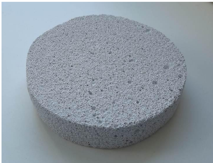
Figure 7. Plaque sciée de matériau d'isolation de silicate de calcium.
