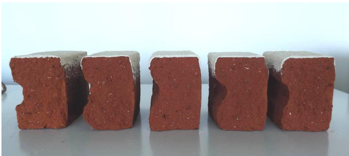
Figure 3. Échantillon de 1 à 5 (de gauche à droite) après le test, cassés au milieu pour mesurer la couche de chaux. La hauteur des échantillons est approximativement de 8,5 cm.
