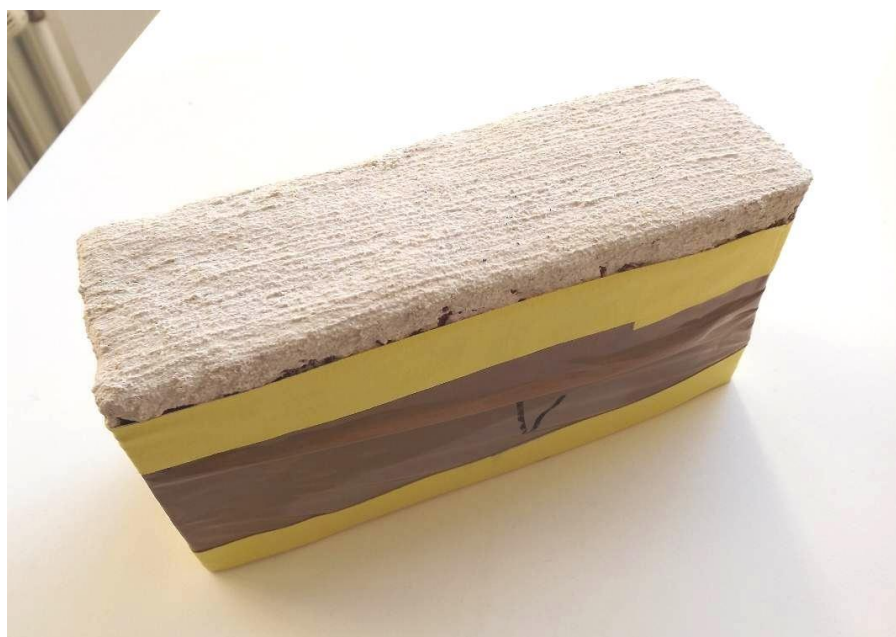
Figure 4. Échantillon 1 avec couche de chaux avant le mesurage d'absorption d'eau. Pendant ce mesurage les côtés latéraux ont été imperméabilisés. Le dessus de la brique, recouvert de RC Chaulage, a été mis en contact avec de l'eau.
