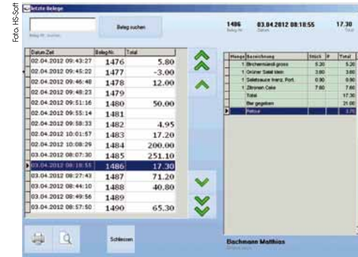
Anzeige der letzten Belege. Das Besondere am System ist, dass die Kassen permanent die Daten an die Zentrale melden. Auch bei einem Hardwaredefekt gehen also keine Informationen verloren.
