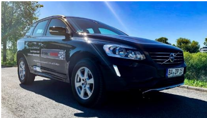
Abbildung 3: Volvo XC 60 mit NOx-MS-Pkw Nachrüstung
