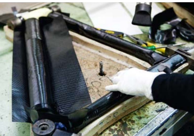
links: Die selbst produzierten Carbonmatten werden verklebt und geföhnt.
