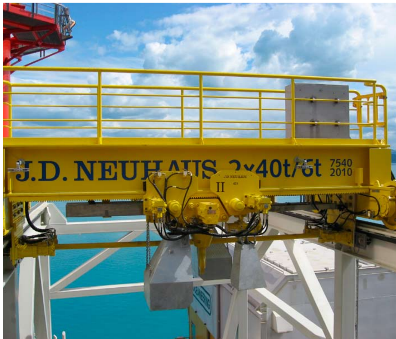
"Aker Spitsbergen" er sammen med "Aker Barents" verdens største borerigger. Bildet viser kranen som er spesialutviklet av Westcon Løfteteknikk i samarbeid med J.D. Neuhaus. Den skal håndtere juletreet under boreoperasjoner.
