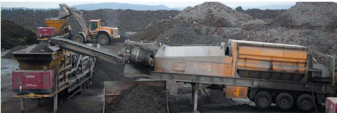
Magnetisk og ikke-magnetisk utsortering av metall fra bunnasken skjer på Støleheia i regi av Avfall Sør Husholdning.
