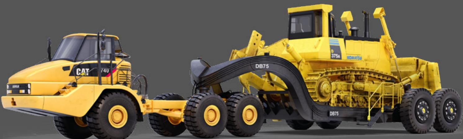
Система Sleipner значительно увеличивает производительность оборудования, используемого на горнодобывающих работах.
